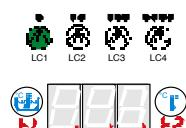
3) Durante la fase di risciacquo viene visualizzata la temperatura del boiler e i led del display si accendono in sequenza;
