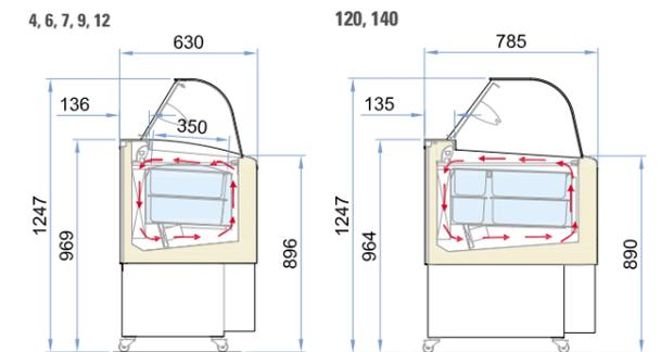
Vetrina gelato promozionale a refrigerazione ventilata. Chiusura lato operatore tramite tendina manuale autoavvolgente. La vetrina è dotata di cella di riserva a refrigerazione statica con evaporatore a mantello.
